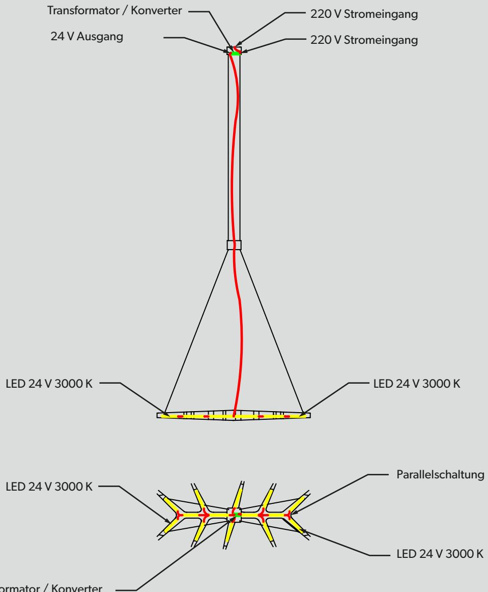
Die in den Transformatoren verwendete Betriebsspannung liegt im Bereich von 110–230 V.
