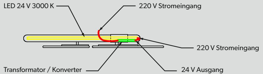
Die in den Transformatoren verwendete Betriebsspannung liegt im Bereich von 110–230 V.
